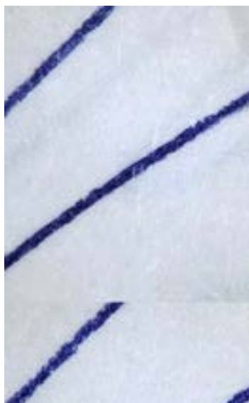
Рисунок 2. Увеличенные изображения фрагментов штрихов, выполненных при помощи плоттера с разной скоростью воспроизведения (снизу - скорость выше, проявляется извилистость)
