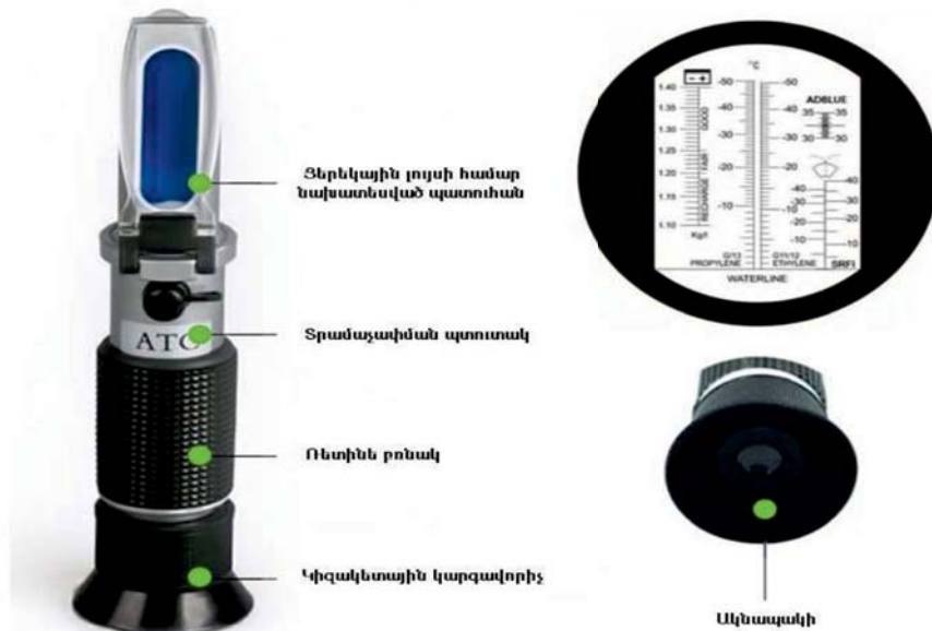
Նկար 2. Արգելակային հեղուկի որակի ստուգման բեկումնաչափ սարք
